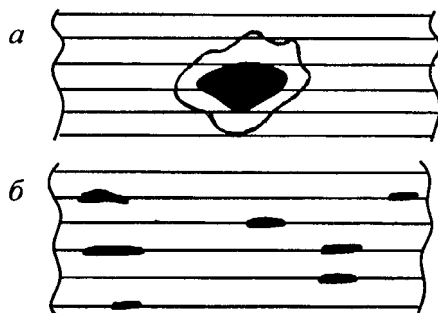
Рис. 14.1. Пятна прогара на конструкциях пола: а — пятна от сгоревшей жидкости; б — "щелевые" прогары
